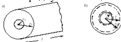
Рис.2.5. Расчет напряженности электрического поля в изоляционных конструкциях с неоднородным полем:
